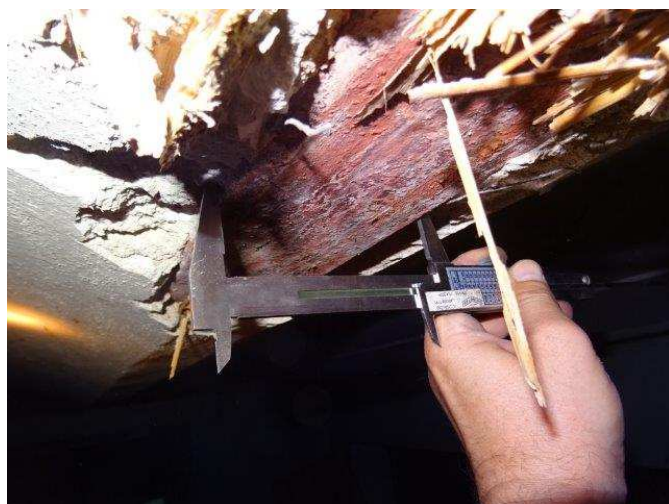
foto /10/ Naměřená šířka profilu P5 - 102 mm
