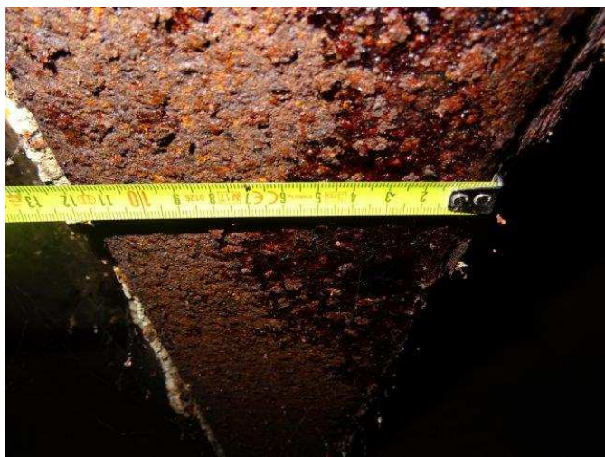
foto /7/ Naměřená šířka profilu P3 - 116 mm
