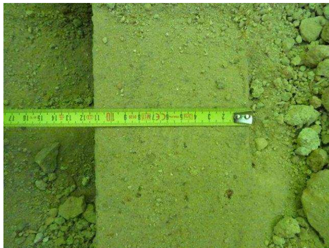
foto /20/ Sonda S5 - naměřená šířka horní pásnice 113 mm
